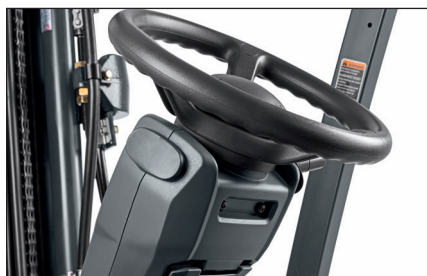
Columna de Dirección con 20 grados de Inclinación
