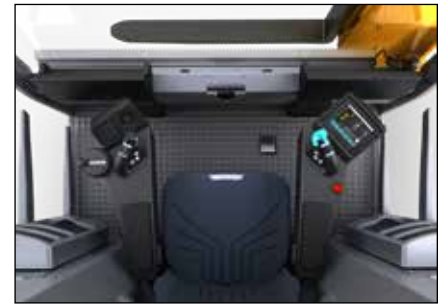
Control de operación dividido (opcional en todas las configuraciones de las series EKX 4 y 5, pero no compatible con paquete de congelador en ningún modelo)
