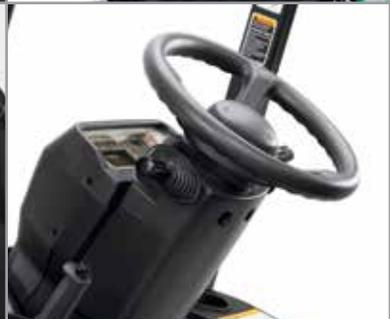
La serie FGC15N-FGC33N viene estándar con Sistema Integrado de Presencia (IPS), el cual se diseñó para desactivar todo desplazamiento propulsado y algo de a funcionalidad hidráulica cuando el operador deja la posición de operación normal. Adicionalmente, suenan alarmas de advertencia y se muestran indicadores en el panel de despliegue, informando al operador y el personal en los alrededores que el sistema está activado.
