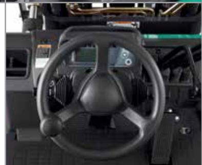
A série FG40N1-FG55N1/FD40NM1-FD55NM1 é fabricada para ajudar a proteger o operador e o pessoal ao redor. Cada unidade tem o padrão com o Sistema de Presença Integrado (Integrated Presence System - IPS), que é projetado para desencatar as funções hidráulicas dos comandos quando o operador sair da posição normal de operação. Além disso, alarmes de advertência e indicadores são exibidos no painel do visor informando ao operador e ao pessoal ao redor que o sistema está acionado.
