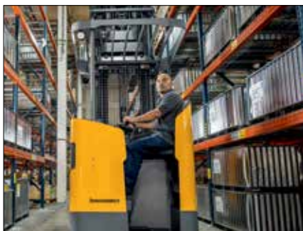
Compartimiento del operador
